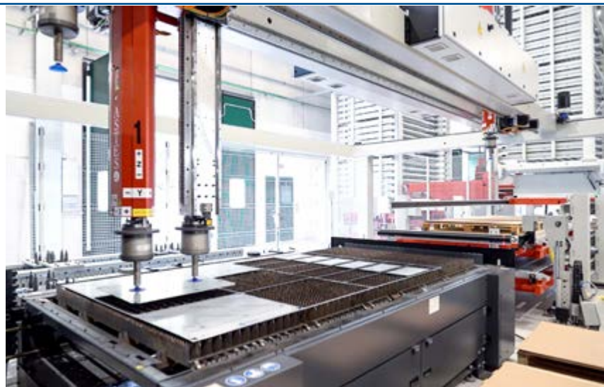
Dettaglio fase di presa pezzo effettuato in CBS con sistema di sorting di Astes4, per successiva pallettizzazione
